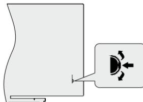
Med kontrollbrytaren kan du styra program- och Quick Standby-on-funktionerna på TV:n.
