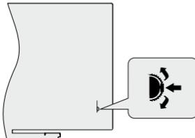
Переключатель управления позволяет управлять функциями программы и включения режима быстрого ожидания телевизора.
